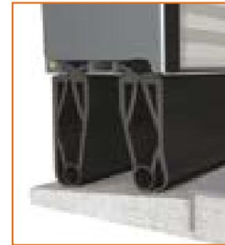
Für den optimalen Bodenabschluss des Tores verwendet Alpha ein doppeltes Gummiprofill mit nach innen gewölbten Dichtlippen. Die Aufnahme der Gummiprofile erfolgt über ein spezielles Kunststoffprofil mit geringer Wärmeleitung. Die Dichtlippe des Gummiprofils schließt eng an die Zargendichtung an.
